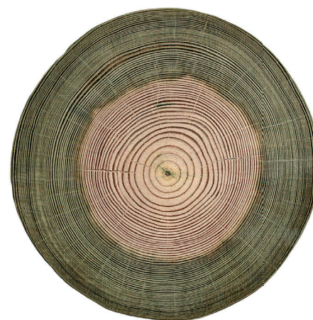
Słupek z drewna sosnowego impregnowany Korasit® KS2: równomierna penetracja całego biału (obszar możliwy do impregnacji).
