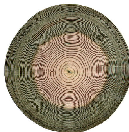
Poteau en pin imprégné de Korasit® KS2 : Pénétration uniforme dans toute la zone de l'aubier (zone imprégnable).
